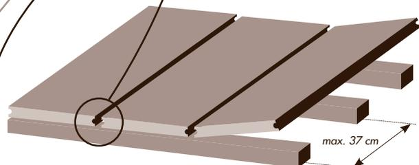
Montage der WPC Terrassendiele auf der WPC Unterkonstruktion (Dimension 30 x 50 oder 40 x 60 mm) mittels WPC Befestigungsclip & Schraube. (Artikel-Nr. 23710199, Verpackungseinheit: 100 Clips inkl. Schrauben und Spezialtorx; Bedarf: pro lfm. WPC Terrassendiele werden ca. 3 Clips benötigt)
