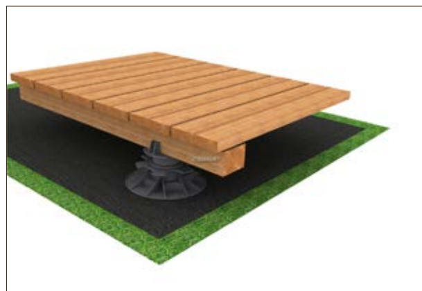
Abbildung: Holzterrassenaufbau mit Terrassenlager auf Unkrautvlies
